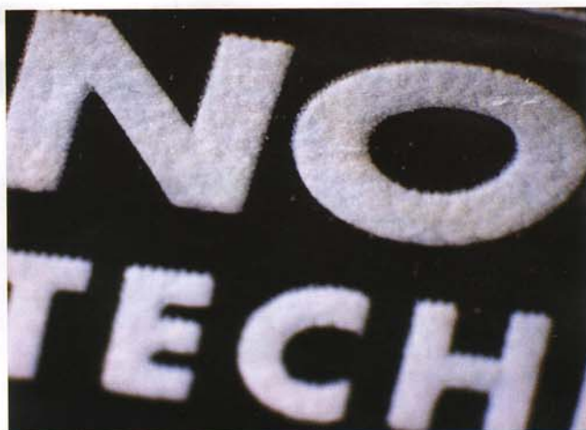
Haptisch attraktive Verpackungen erhöhen den Kaufanreiz. Mit Laser aktivierbares schäumbares Material macht die Folie spürbar
